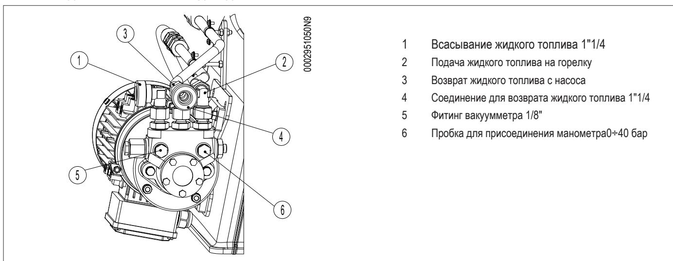
**СХЕМА ПОДКЛЮЧЕНИЯ НАСОСА ВД МОДЕЛИ VBHRG**
