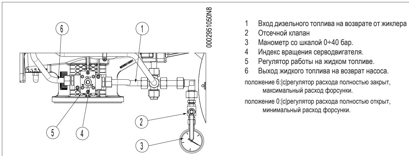
**СХЕМА ПОДКЛЮЧЕНИЯ НАСОСА ВД МОДЕЛИ NVBGRGZ**
