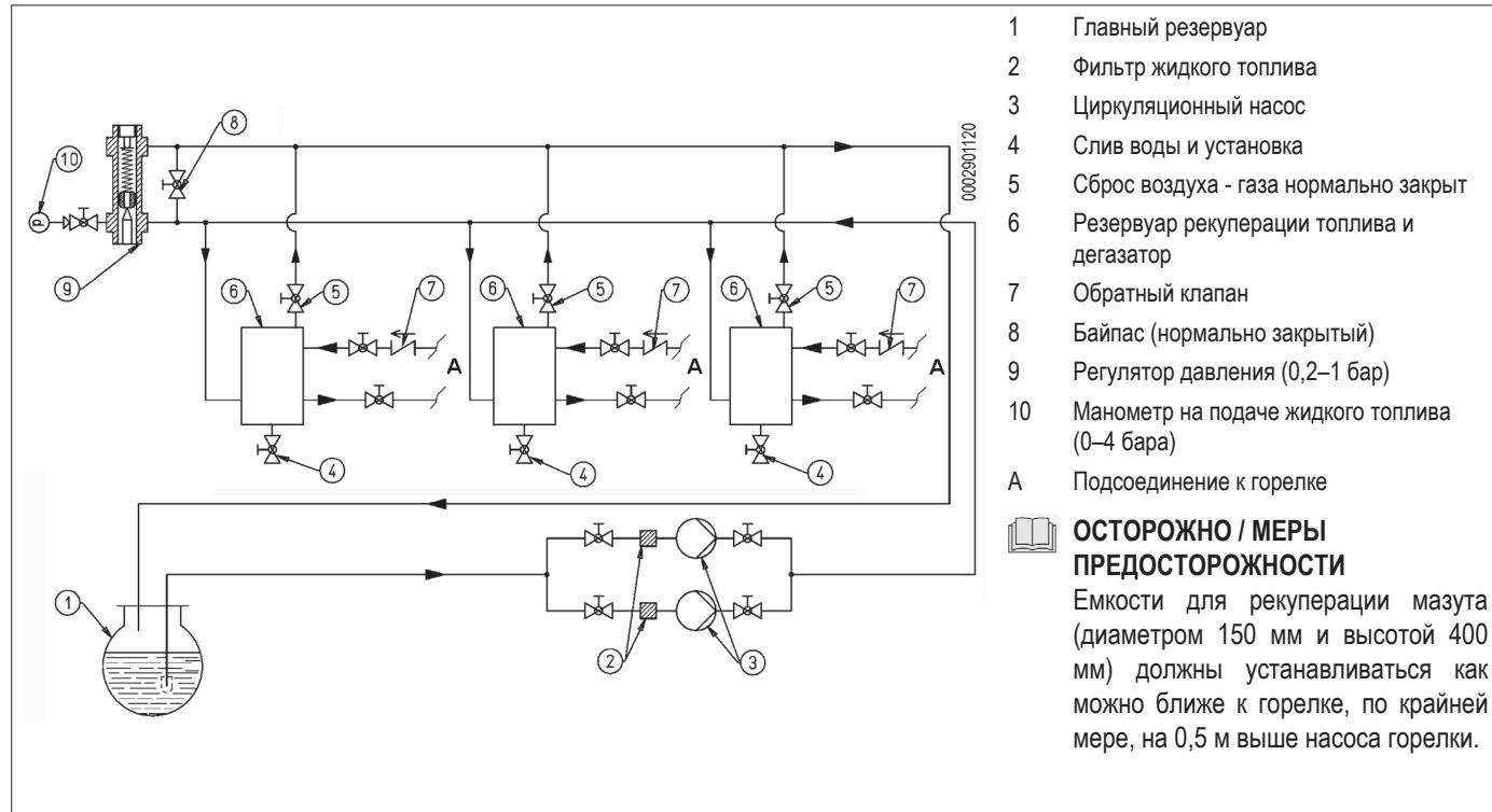
**ПРИНЦИПИАЛЬНАЯ ГИДРАВЛИЧЕСКАЯ СХЕМА ПОДАЧИ ТОПЛИВА ОДНОЙ ИЛИ НЕСКОЛЬКИМ ДВУХСТУПЕНЧАТЫМ ИЛИ МОДУЛИРУЮЩИМ ГОРЕЛКАМ С МАКСИМАЛЬНОЙ НОМИНАЛЬНОЙ ВЯЗКОСТЬЮ ТОПЛИВА (5° ЭНГЛЕР ПРИ 50°C).**
