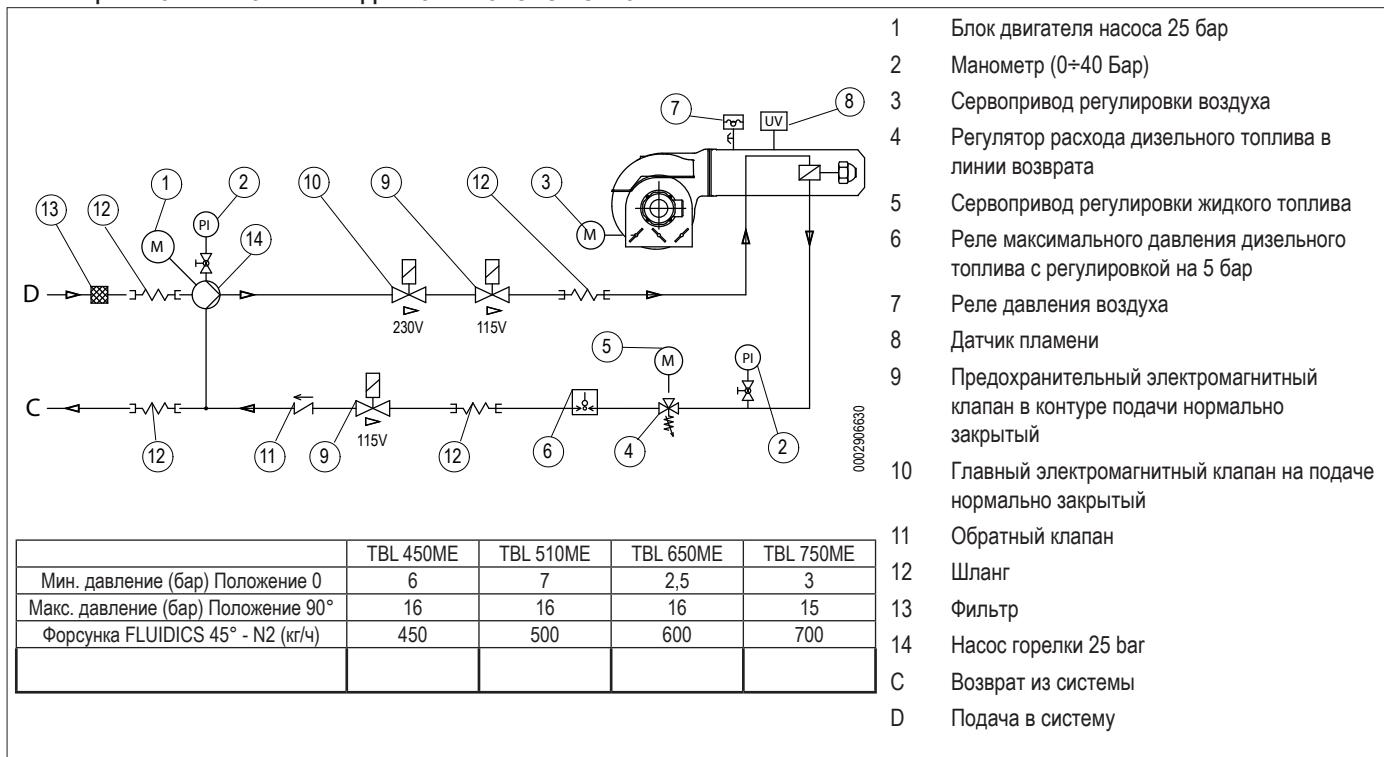
**ПРИНЦИПИАЛЬНАЯ ГИДРАВЛИЧЕСКАЯ СХЕМА ПОДАЧИ ТОПЛИВА ПОД ДАВЛЕНИЕМ ДЛЯ ОДНОЙ ИЛИ НЕСКОЛЬКИХ ДВУХСТУПЕНЧАТЫХ ИЛИ МОДУЛИРУЮЩИХ ГОРЕЛОК С МАКСИМАЛЬНОЙ НОМИНАЛЬНОЙ ВЯЗКОСТЬЮ ТОПЛИВА (5° ЭНГЛЕР ПРИ 50°C) С РЕГУЛЯТОРОМ ДАВЛЕНИЯ**
